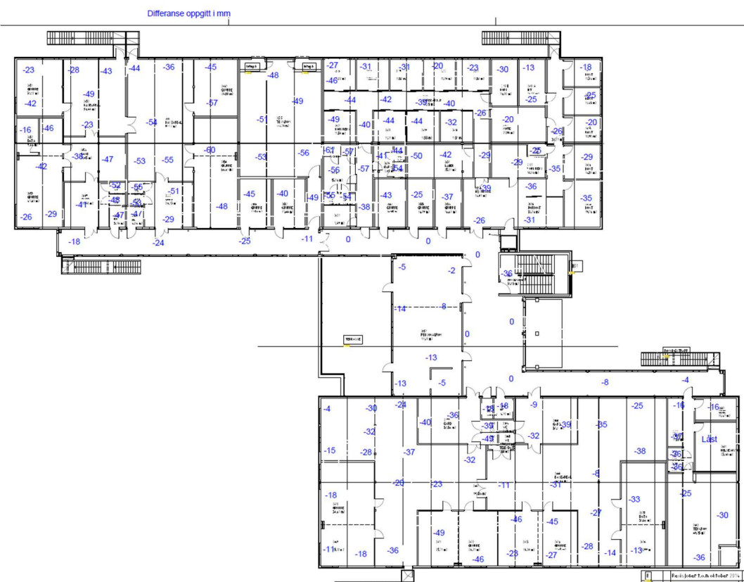
Figur 5 Setningsmålinger for plan 2 [mm]
